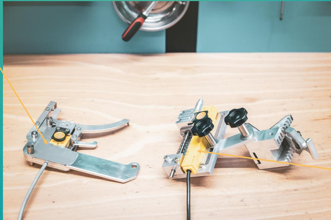
ms4bike Sensor zum Abtasten des Seitenschlages
