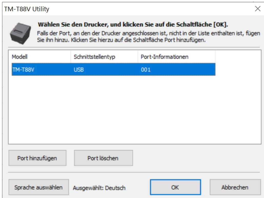
Nun stellen Sie die Druckdichte in folgenden Schritten auf das Maximum von 130% ein und reduzieren Sie die Druckgeschwindigkeit auf einen Wert zwischen 8 und 10:
